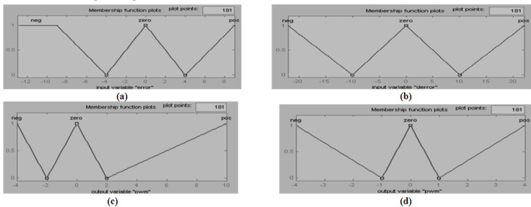
**Fig. 5:** Input membership function of (a) error (d) delta error, output membership function (c) FLC-1, (d) FLC-2
