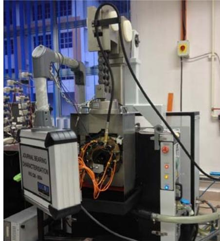
**Fig. 1:** Journal bearing test rig
