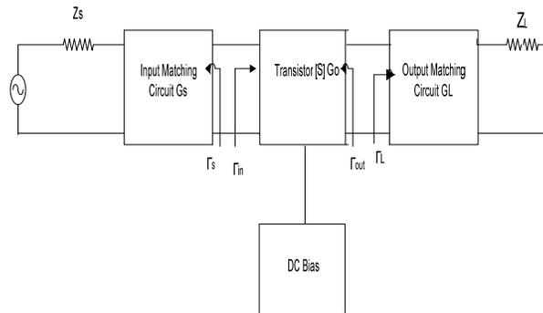
**Fig. 2:** Typical LNA amplifier
