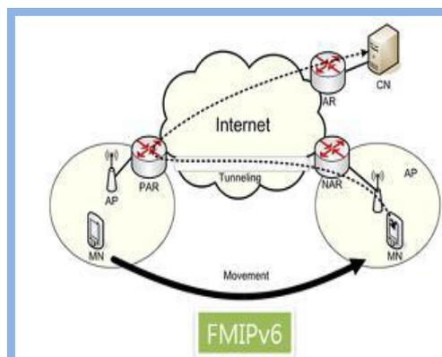
**Fig. 4:** Network Diagram of FMIPv6.
