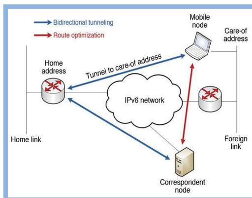
**Fig. 2:** MIPv6 Network Diagram.
