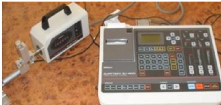
**Fig. 3:** Surface roughness apparatus (surfteS Sv-400)
