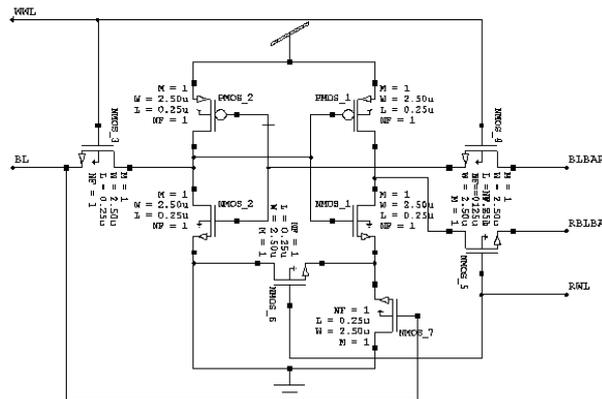
**Fig. 4:** 9T SRAM cell.
